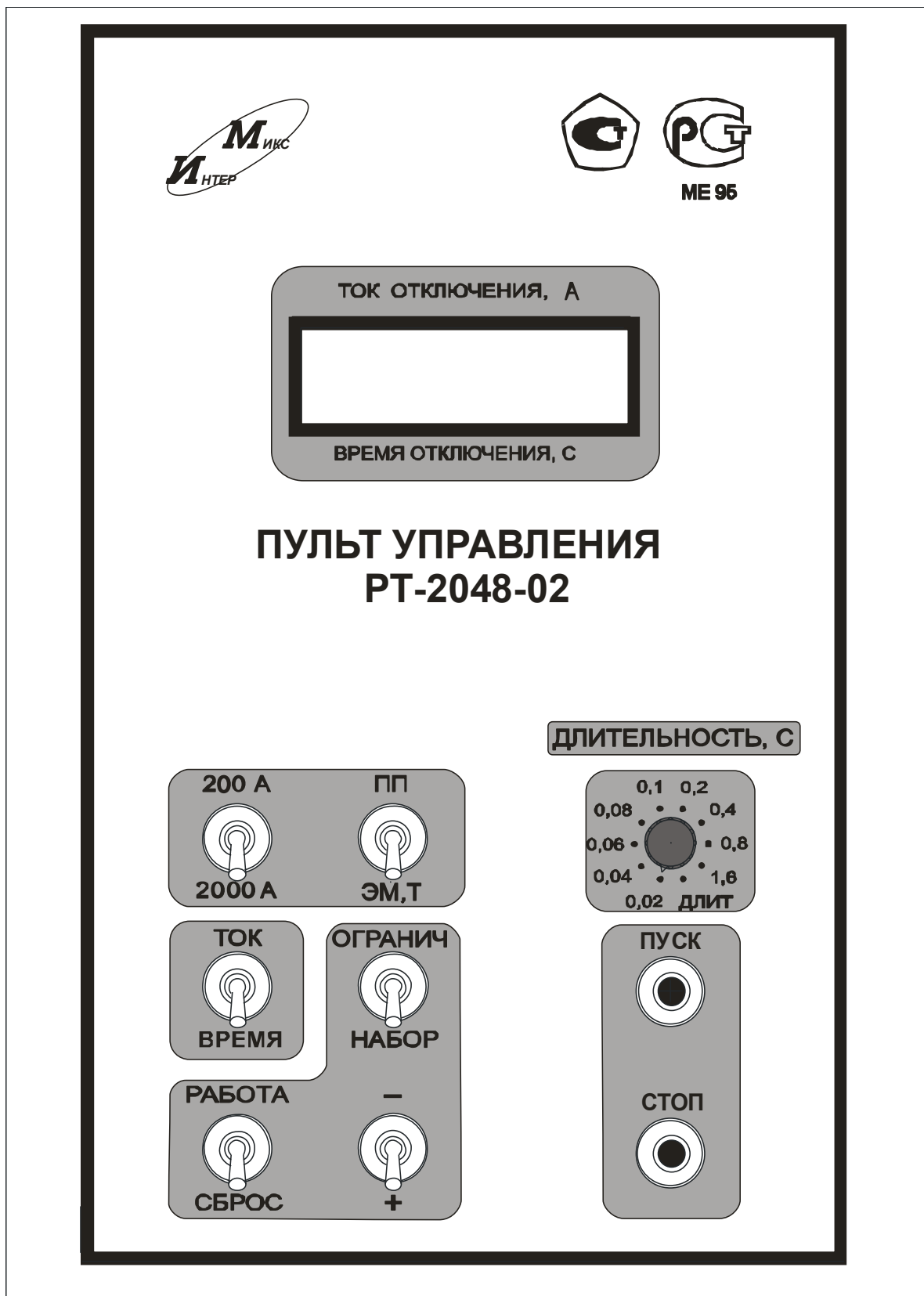
Рис. П1.3 Внешний вид лицевой панели ПУ РТ-2048-02
